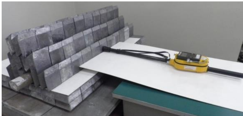
FIGURA 12- Arranjo experimental para teste de homogeneidade com detector AD 6150 Automess
