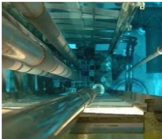
FIGURA 8- barras de controle do reator de pesquisa IEA-R1 vistas de cima
